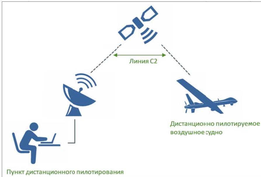
Рис. 11-2. Примеры BRLOS: ПДП и ДПВС с доступом через спутник
