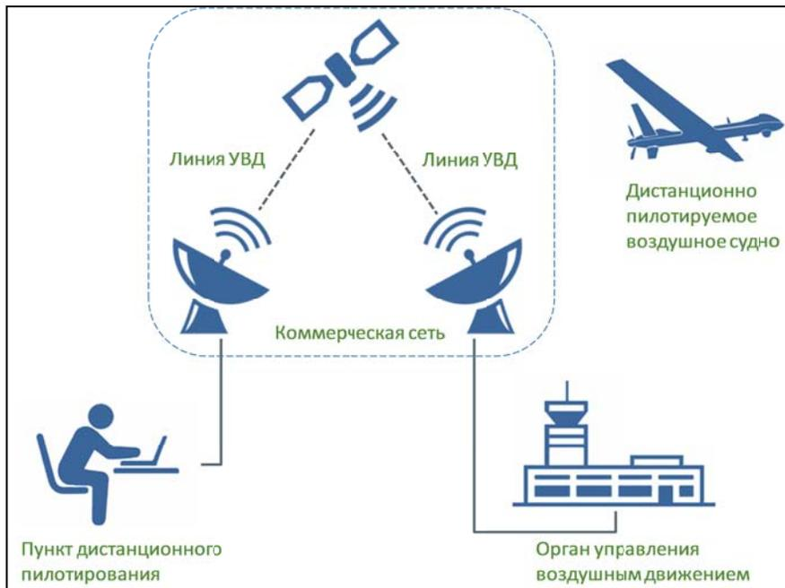
**Рис. 12-7. Архитектура, включающая спутниковую сеть**
